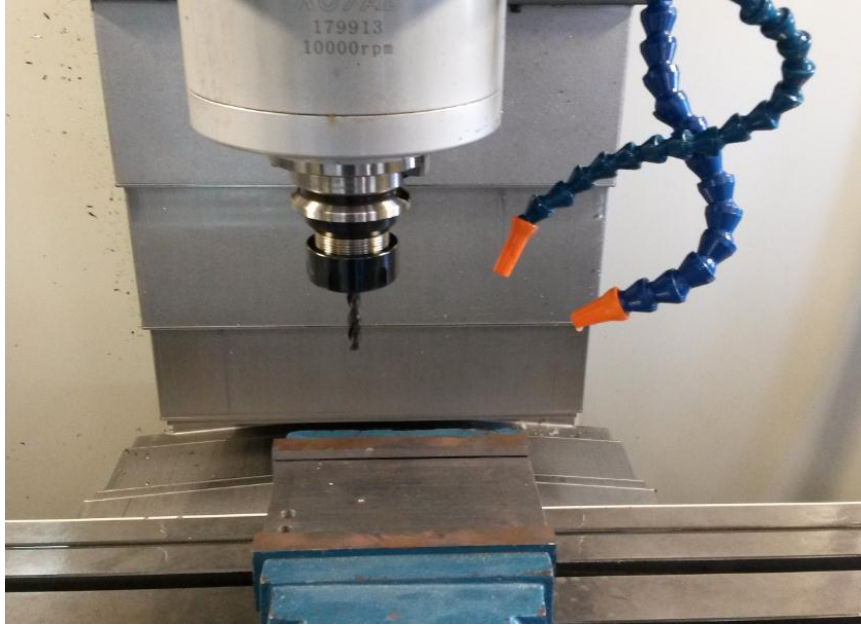
Şekil 1. Delik Delme İşleminin Yapıldığı Deney Düzeneği
